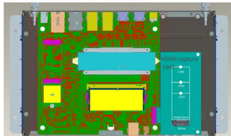
模組化設計:主機板 + HDMI擷取卡
